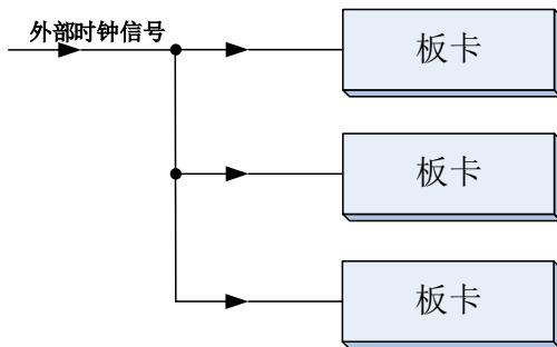
图4-10-4 外时钟同步采集的连接方式
