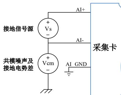
图 4-5-6 接地信号源的差分 (DIFF) 连接
