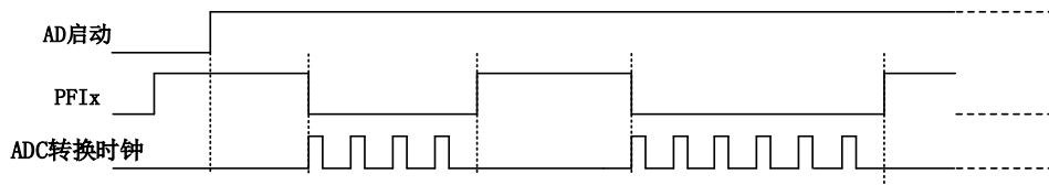
图 8-2-8 暂停触发—高电平暂停
