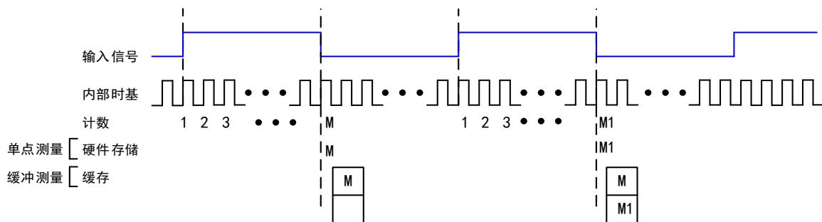
图 6-4-1 脉宽测量上升沿有效示意图
