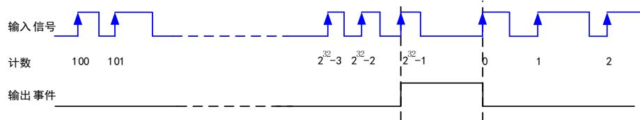
图 6-8-1 脉冲方式输出
