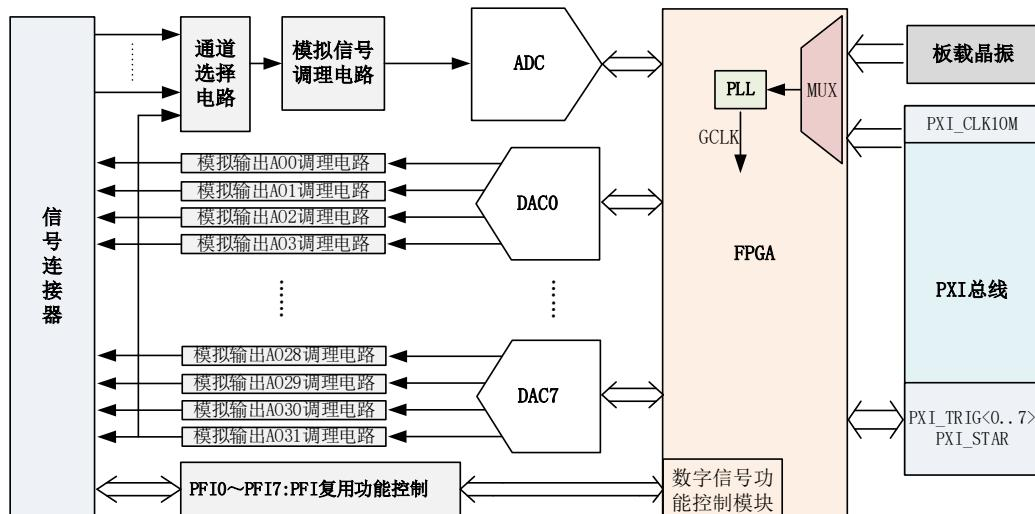
图2-1 PXI9320D系统框图
