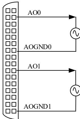
图5-2-1 AO模拟量输出连接
