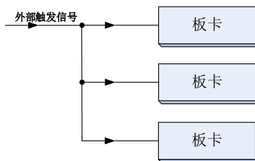
图 4-10-3 外触发同步采集的连接方式
