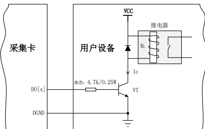
图 7-3-3 DO 数字量控制继电器电路
