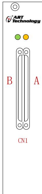
图 3-3-1 VHDCI-68 连接器挡片示意图
