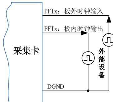
图5-6-1 时钟输入输出的连接
