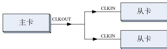
图 4-10-2 主从卡级联同步采集的连接方式
