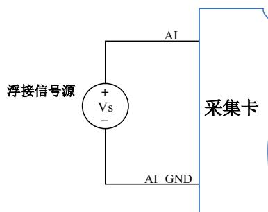
图 4-5-5 浮接信号源的参考地单端 (RSE) 连接
