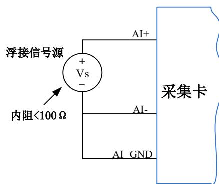
图 4-5-1 浮接信号源差分 (DIFF) 连接 -- 直接连接
