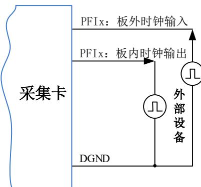
图 4-7-1 时钟输入输出的连接
